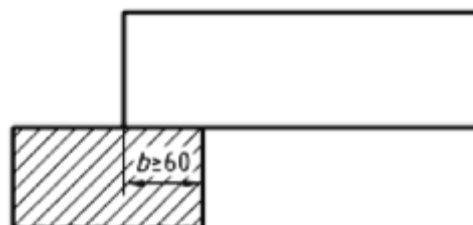
b) belka bez wystającego zbrojenia
